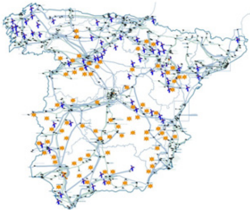
Figura 23. Distribución nodal de nueva generación eólica (18.000 MW) y fotovoltaica (19.000 MW) en el escenario de estudio
